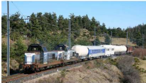
Figure 2 : train désherbeur à grands rendements High efficiency weed sprayer train
