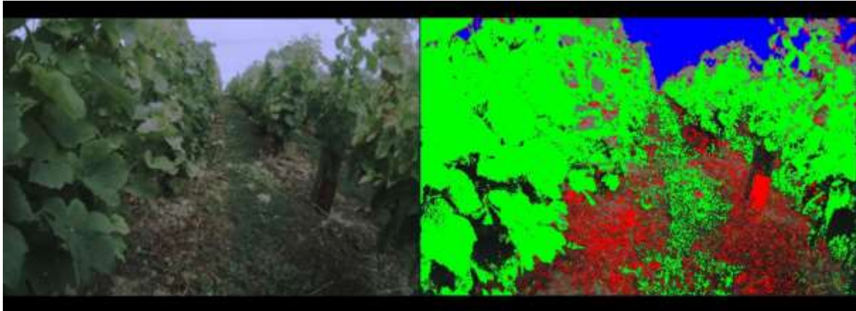
Figure 2 : Image brute et image traitée issue du capteur de vision stéréoscopique utilisé sur le robot. Raw and processed pictures from the vision camera of the robot
