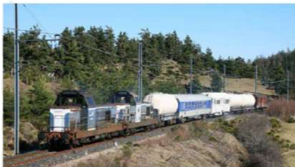
Figure 2 : train désherbeur à grands rendements National train (high efficiency train)
