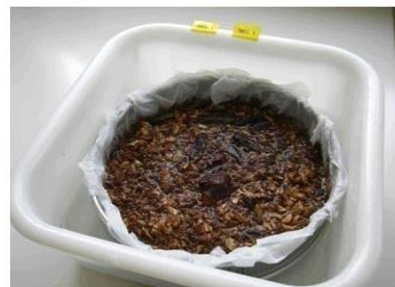
Figure 2 : migration sur tamis des échantillons (Photo Anses-LSV)
