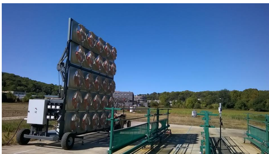
Fig 4 : Banc Eole Drift avec la vigne artificielle /Eole Drift test bench with the artificial vineyard
