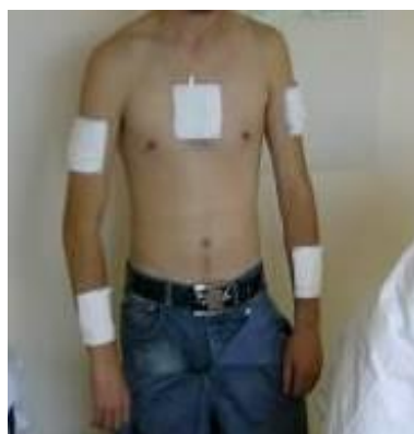
Mesures de contacts, par exemple par pose de dosimètres sur la peau ou prélèvement par gaze humide dans un véhicule personnel.
