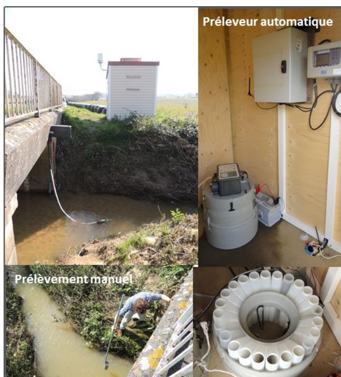
Figure 5 : Photographies des deux systèmes de prélèvements pour le suivi de la qualité de l'eau. Photos illustrating the two sampling systems for the water quality monitoring.
