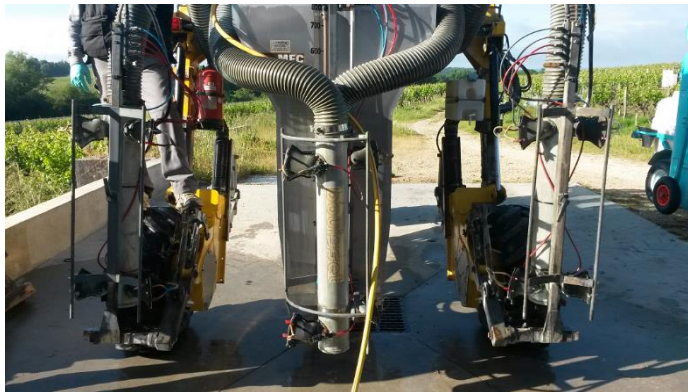
Figure 1 : Pulvérisateur utilisé. Sayer used
