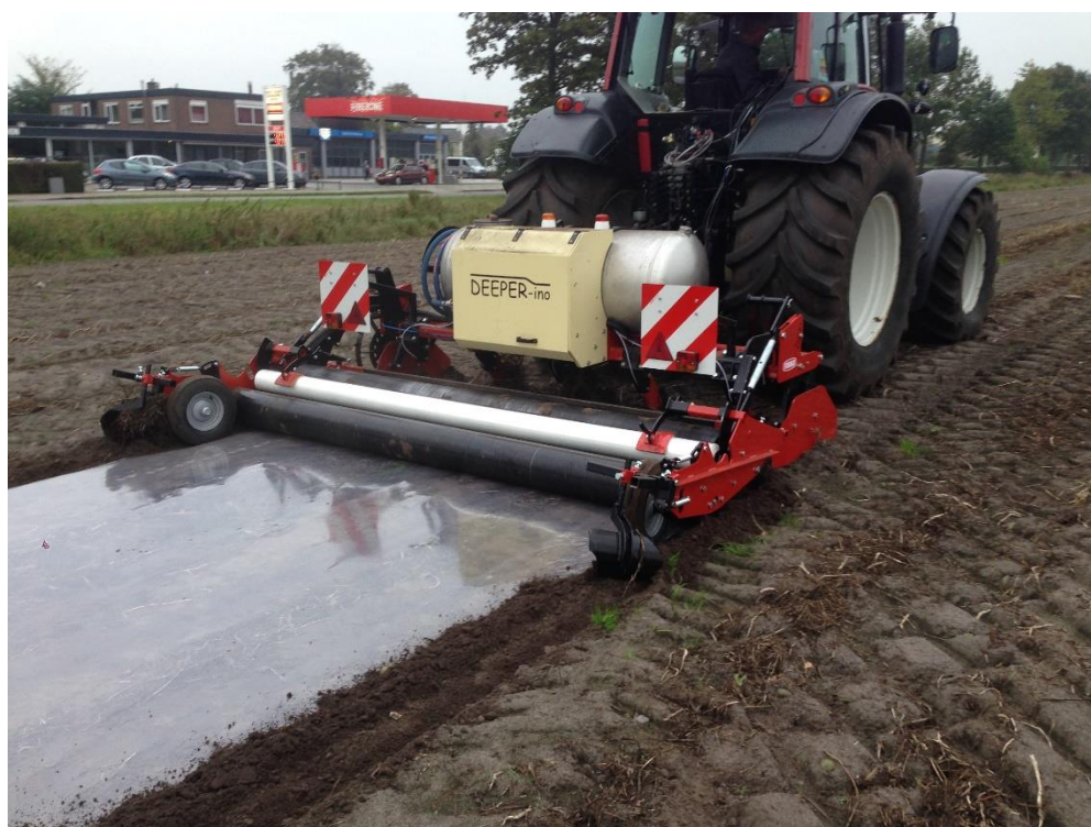
Machine d'injection de fumigant liquide, combinée à une dérouleuse de plastique barrière
