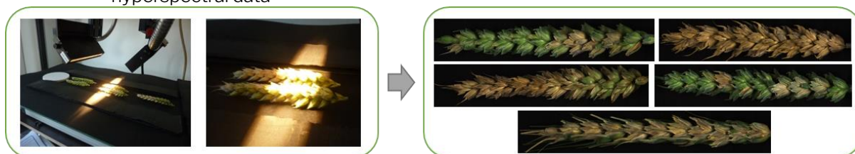
Figure 1: Acquisition avec la caméra hyperspectrale et exemples d'images RVB reconstruites à partir des données hyperspectrales Hyperspectral camera acquisition and examples of RGB images reconstructed from hyperspectral data
