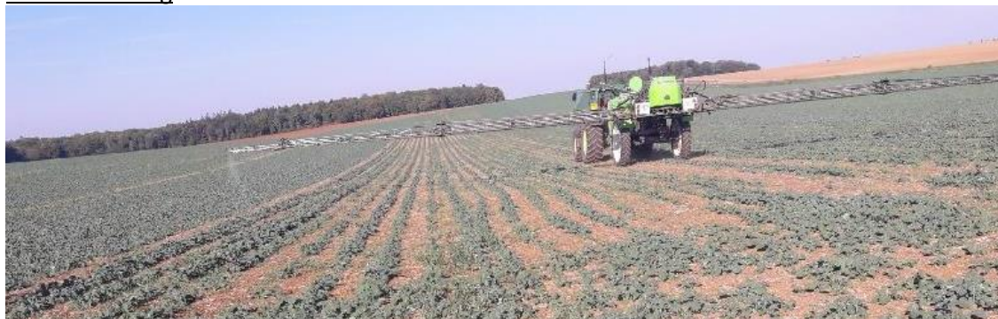
Figure 2 : pulvérisateur avec coupures de tronçons lors du traitement ciblé ; boom sprayer with sections cutting
